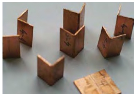
Biegetests längs und quer zur Schweißnaht, Radius 1mm, 90°
